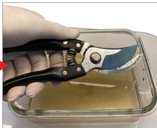
b) Kéo tỉa cây được làm sạch một phần gỉ sét sau khi ngâm vào giấm ăn
