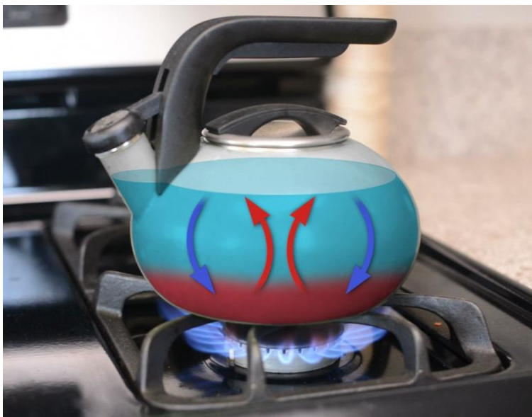
Hình. Sự đối lưu trong nước khi bị đun nóng
