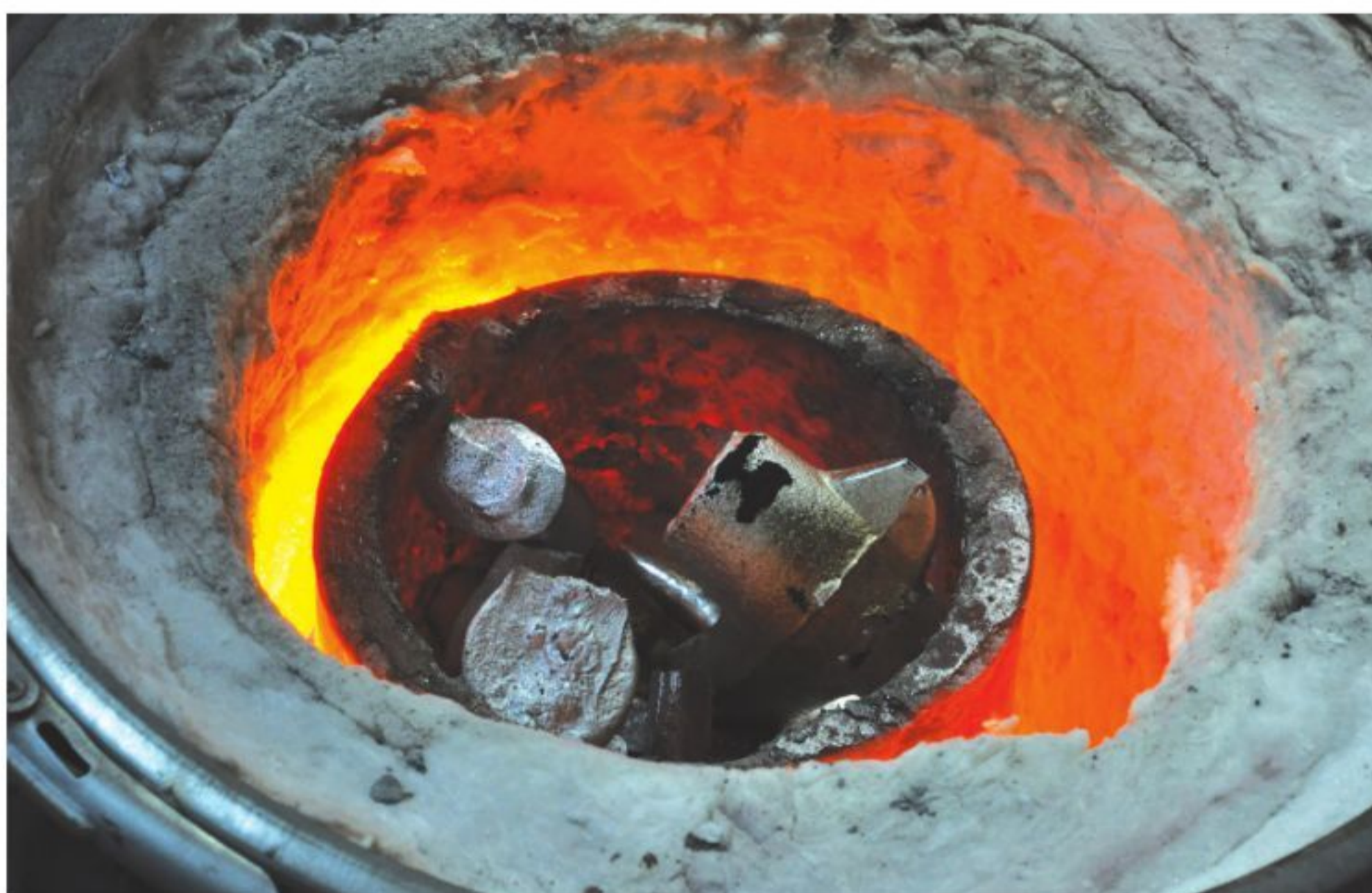
Hình 3.8. Nung chảy phế liệu nhôm bằng lò nung nhỏ tại hộ gia đình
