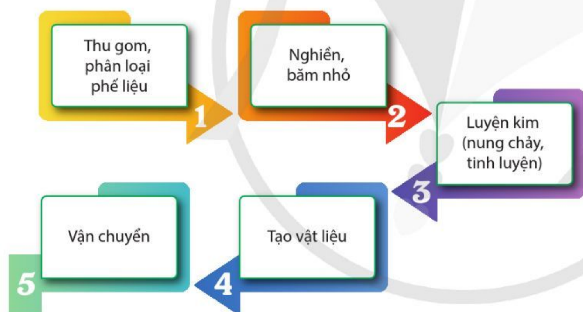
Hình 3.2. Sơ đồ các công đoạn cơ bản trong quy trình tái chế kim loại
