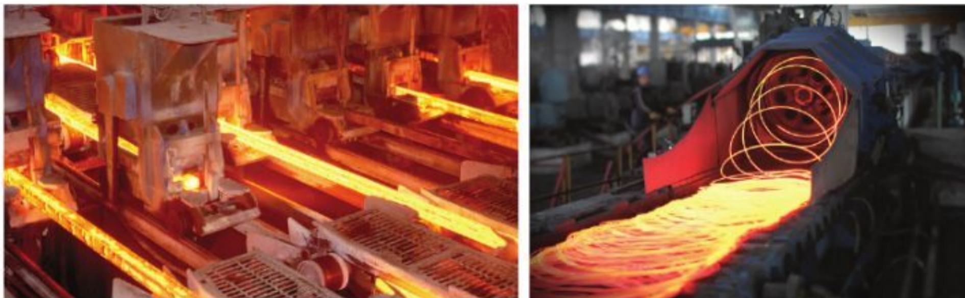
Hình 3.5. Vật liệu kim loại tái chế được đổ khuôn hoặc kéo sợi
